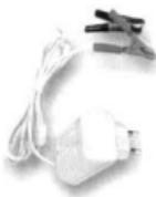
**Подзарядное устройство «Кедр-авто-мини»** предназначено для подзарядки 12-вольтовых свинцово-кислотных аккумуляторных батарей как автомобильных, так и мотоциклетных. Зарядка аккумуляторной батареи малым током (0,3 А) обеспечивает максимальный срок службы аккумулятора. Устройство предназначено для продолжительной работы и не приводит к перезарядке аккумулятора и его «закипанию».
